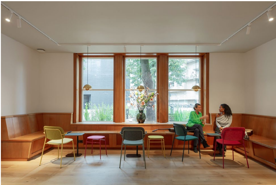
Oude kerkbanken zijn omgevormd tot zitmeubilair en lambrisering, bestaande houten kozijnen zijn zorgvuldig gerepareerd en behouden het erfgoed van het gebouw.
